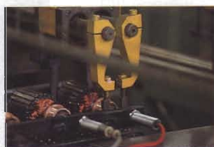
Equilibratura per asportazione di materiale.
