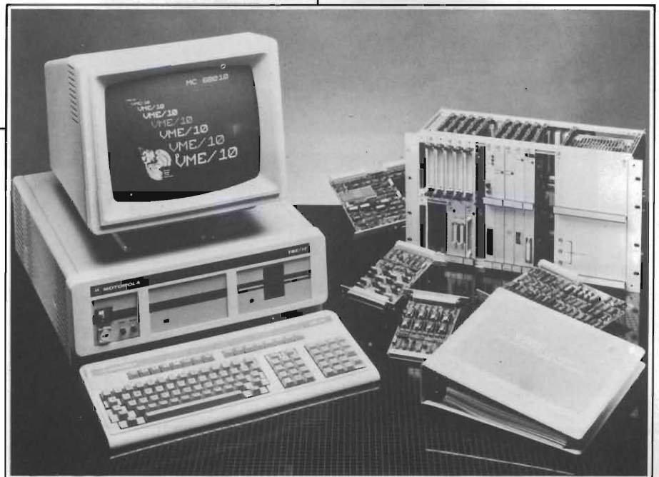
Fig. 1 - Il VME/10, un sistema versatile che può essere usato sia come stazione di sviluppo che come sistema OEM. Si tratta di una tipica stazione singola.
