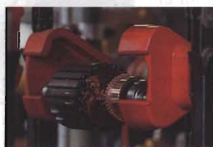
Stazione accumulo di rotori finiti.
