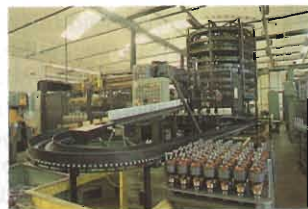
Impianto di resinatura degli statori.
